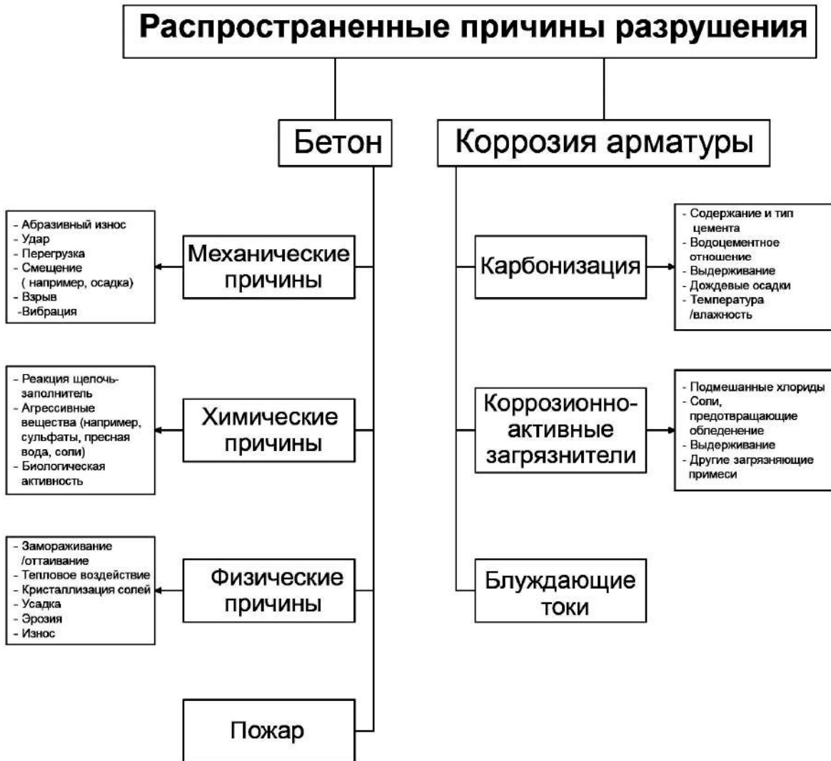
Рисунок 5.2 – Распространенные причины разрушений конструкций
