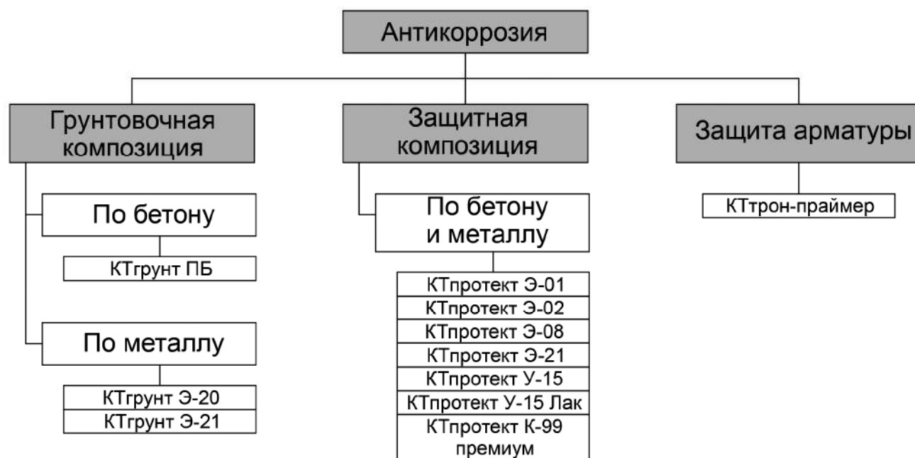
Рисунок 4.2 – Схема классификации антикоррозионных материалов «КТТрон»
