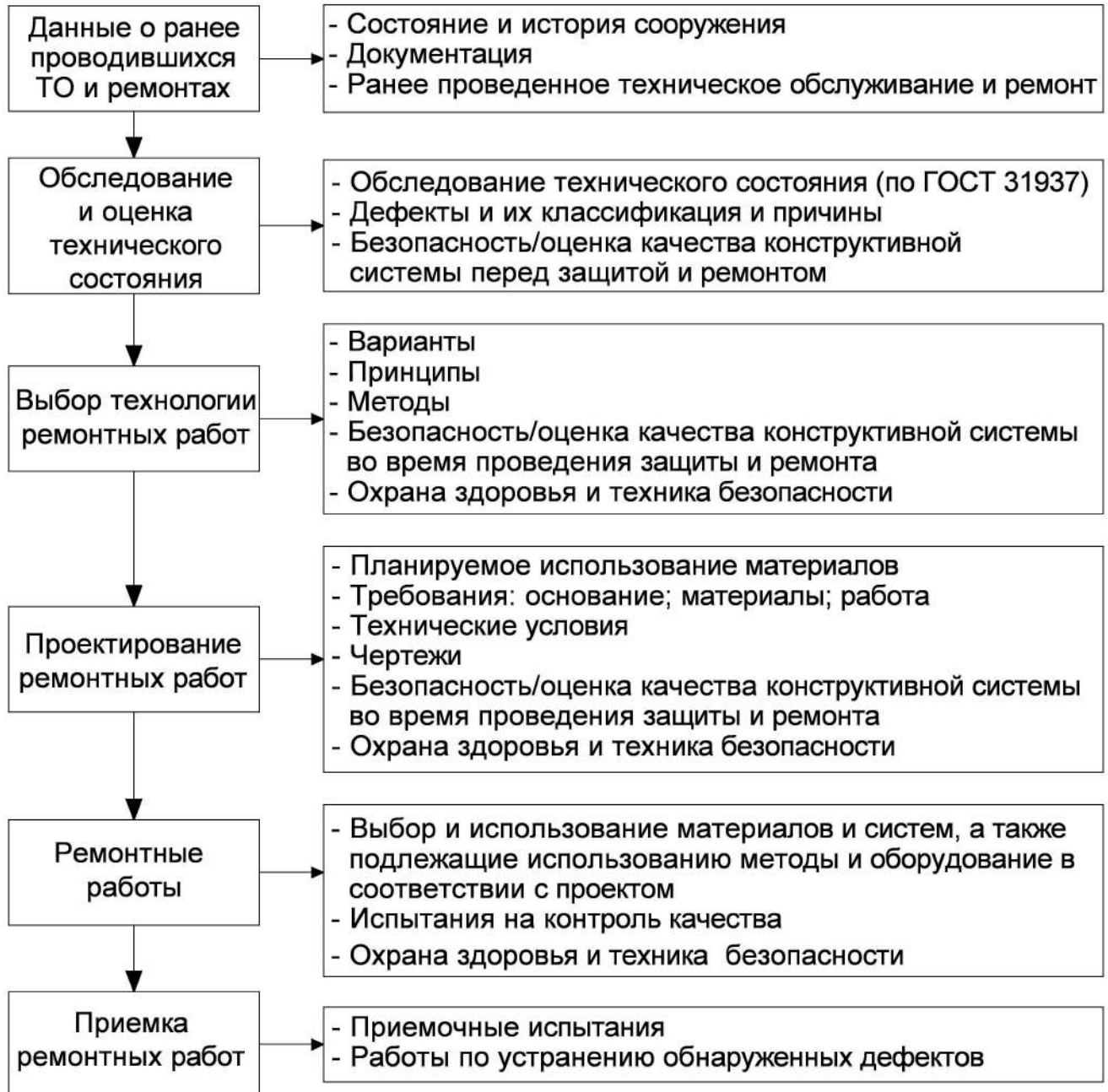
Рисунок 5.1 – Этапы стандартного проекта по ремонту
